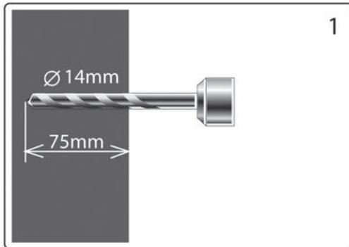
1. Bohren Sie mit einem 14 mm Steinbohrer zwei 75 mm tiefe Löcher an den angezeichneten Stellen.
