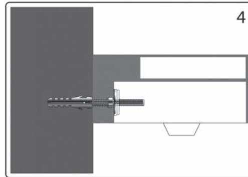
4. Positionieren Sie das Becken an der Wand, indem Sie die Stockschrauben durch die Bohrungen am Becken führen. Stecken Sie zuerst eine Bundhülse, danach eine Unterlegscheibe auf die Stockschraube.
