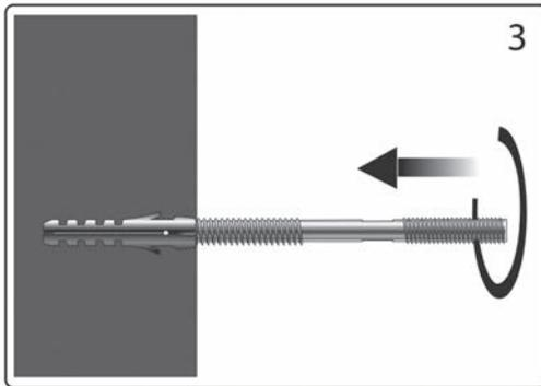
3. Drehen Sie die Stockschrauben mit einem 8-mm-Schlüssel in die Dübel bis der Schlüssel Wandkontakt hat.
